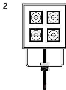
2.- Inserte la estaca en el tornillo pasacable roscándola y saque el cable por el orificio lateral de la estaca.
