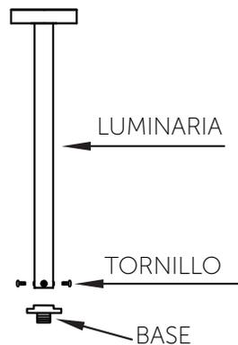
2. Ubique el lugar donde instalará la luminaria y realice las preparaciones correspondientes: ducto, registro y cable de alimentación.
