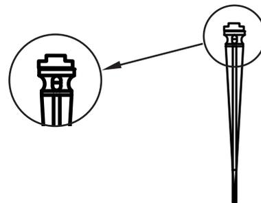
4. Inserte la estaca en el piso golpeándola con un martillo sobre la cara de la base.
