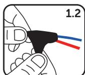
1.2 Coloque la cinta masilla en el segundo conductor, incorporando este al primer conductor de ambos cables, de alimentación eléctrica y de la luminaria
