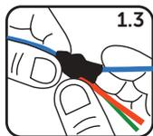
1.3 Coloque la cinta masilla en el tercer conductor, incorporando este último con los dos anteriores en ambos cables, de alimentación eléctrica y cable de la luminaria.
