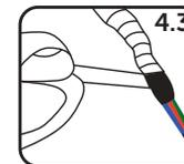
5. Recubra todo aislamiento con la cinta vinil del cable de alimentación en dirección al cable de la luminaria.
