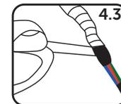
5. Recubra todo aislamiento con la cinta vinil del cable de alimentación en dirección al cable de la luminaria.
