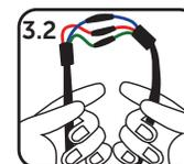
4. Realice el aislamiento cubriendo la cinta vulcanizable desde el conductor de alimentación en dirección del cable de la luminaria.
