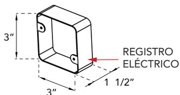
2.- Retire la base de la luminaria y colóquela en el registro eléctrico como se muestra en la siguiente imagen.
