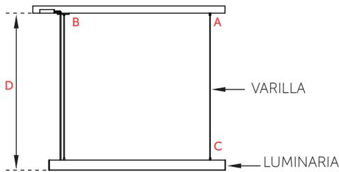
**A)** Realice una perforación de 14 mm en el falso plafón para insertar el sujetador mariposa tal y como se muestra.
