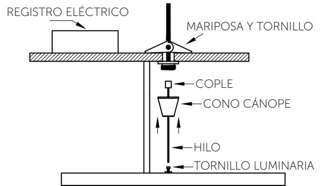
**E)** Para introducir el hilo que suspende la luminaria, asegúrese que la rosca del tornillo de la luminaria esté lo suficientemente aflojada para poder introducir el cable.
