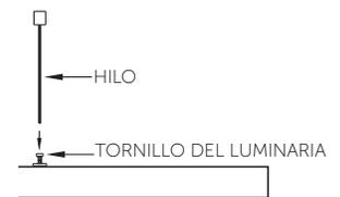
**D)** Introduzca el hilo para ajustar la altura a la que estará posicionada la luminaria, para finalizar apriete la rosca del tornillo para asegurar la posición del cable.
