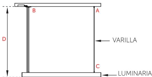
**A)** Perfore el techo con una broca de 1/4 para colocar el taquete. Coloque el taquete y atornille la tapa del cónope como se muestra en la siguiente figura.
