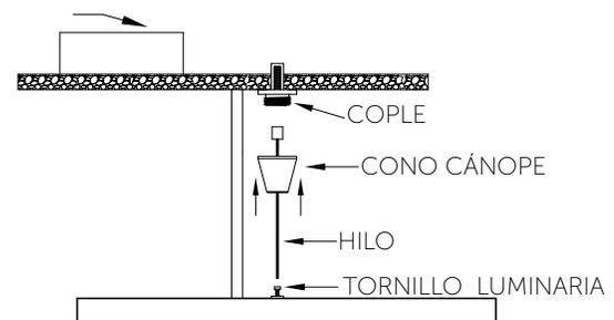
**C)** Para introducir el hilo que suspende a la luminaria, asegúrese que la rosca del tornillo de la luminaria esté lo suficientemente aflojada para poder introducir el cable.
