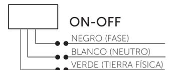
**IMPORTANTE:** Antes de realizar las conexiones eléctricas verifique las etiquetas de conexión que acompañan a los cables la luminaria (alimentación y dimmer 0-10 V).
