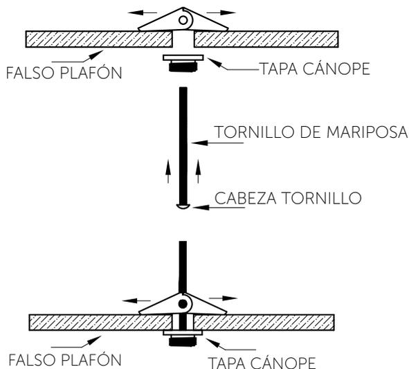
**D)** Coloque el cónope cónico en la tapa del cónope y ajústelo roscándolo hacia la derecha como se muestra en la imagen.
