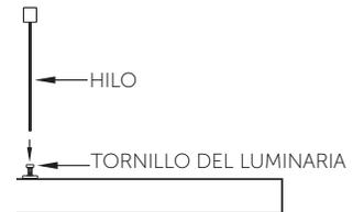
**F)** Introduzca el hilo para ajustar la altura a la que estará posicionada la luminaria, para finalizar ajuste la rosca del tornillo para asegurar la posición del cable.
