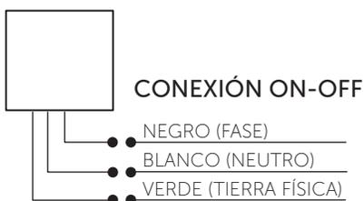
**IMPORTANTE:** Antes de realizar las conexiones eléctricas verifique las etiquetas de conexión que acompañan a los cables la luminaria (alimentación y dimmer 0-10 V).
