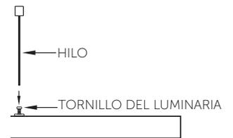
**F)** Introduzca el hilo para ajustar la altura a la que estará posicionada la luminaria, para finalizar ajuste la rosca del tornillo para asegurar la posición del cable.
