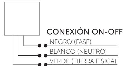
**IMPORTANTE:** Antes de realizar las conexiones eléctricas verifique las etiquetas de conexión que acompañan a los cables la luminaria (alimentación y dimmer 0-10 V).
