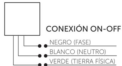
**IMPORTANTE:** Antes de realizar las conexiones eléctricas verifique las etiquetas de conexión que acompañan a los cables de la luminaria (alimentación y dimmer 0-10 V).
