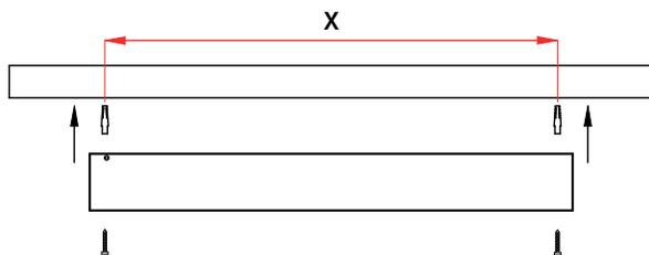
**1.1.** Para fijar el cuerpo de la luminaria a los tornillos será necesario desconectar el circuito electrónico de la fuente de poder, asegúrese de realizarlo como se muestra en la figura.
