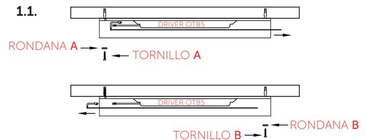
**1.2.** Inserte el cuerpo de la luminaria a los tornillos haciendo coincidir las ranuras, desplace el cuerpo de la luminaria hacia la derecha para que la cabeza del tornillo trabe. Para facilitar la instalación desplace el circuito hacia los extremos para poder apretar los tornillos.
